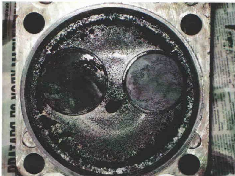
Рисунок В.20 – Огневое днище головки цилиндра двигателя, заправленного опытным маслом
