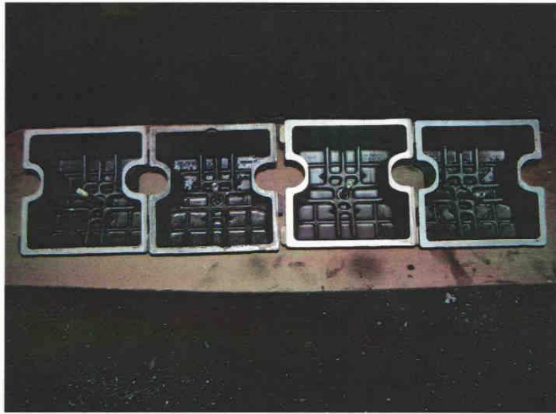
Рисунок В.21 – Внутренняя поверхность крышек головок цилиндров двигателя, заправленного штатным маслом
