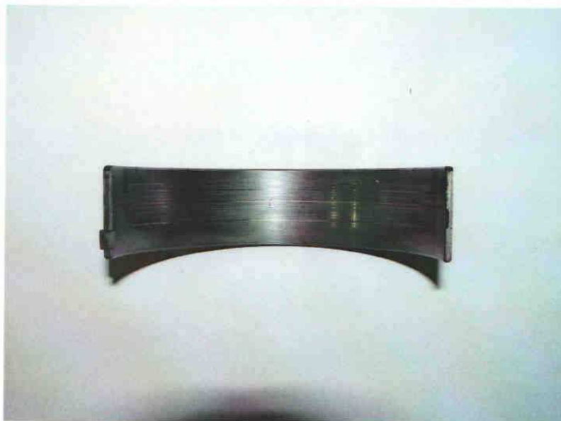
Рисунок В.12 – Вкладыш коренного подшипника со следами задира (двигатель, заправленный штатным маслом)
