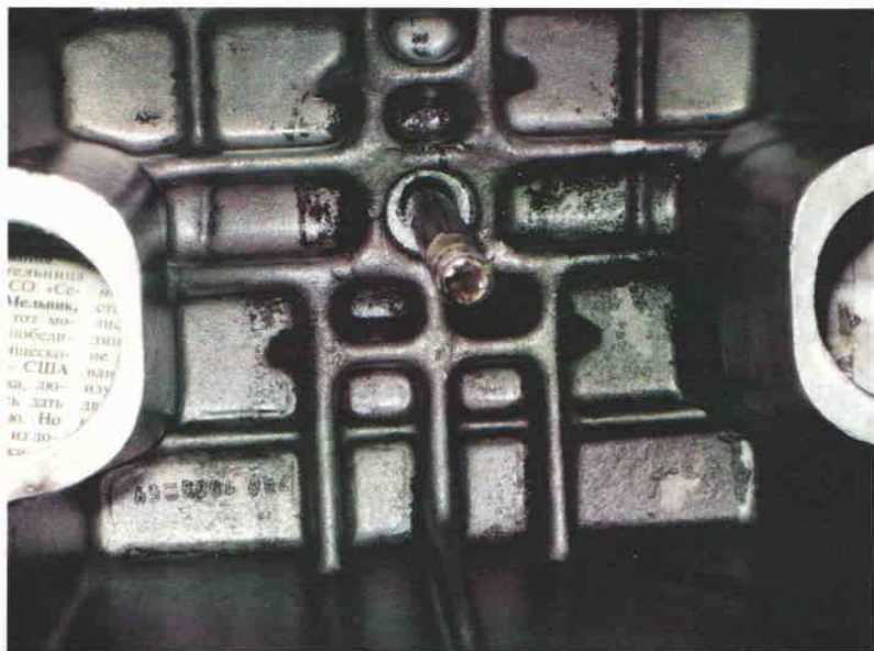
Рисунок В.22 – Внутренняя поверхность крышки головки цилиндра двигателя, заправленного опытным маслом
